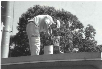
水象気象局点検 (雨量計の清掃状況です)
